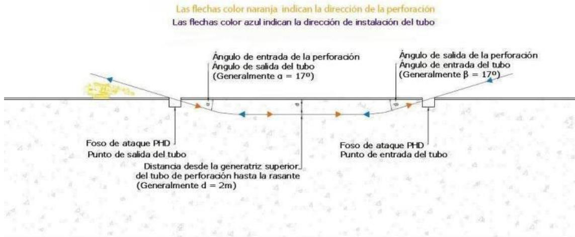
Figura 5. Esquema de perforación e instalación del tubo cruzamiento en la carretera N-234
