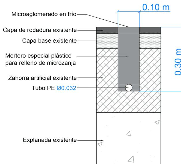
Figura 4. Esquema de microzanja en pavimento.
