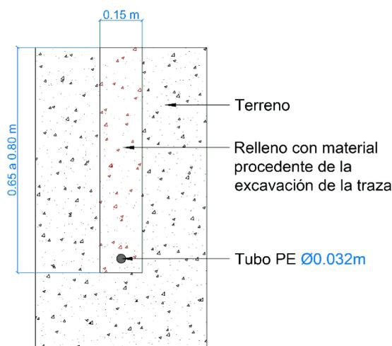
Figura 3. Esquema de microzanja en camino.
